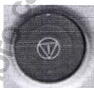
Рисунок 3.6 – Аварийный выключатель на боковой панели гантри
